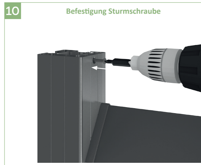
10 | Langes Distanzstück mit der Sturm-Schutz-Schraube ST4,2 x 32mm am Pfosten verschrauben.
