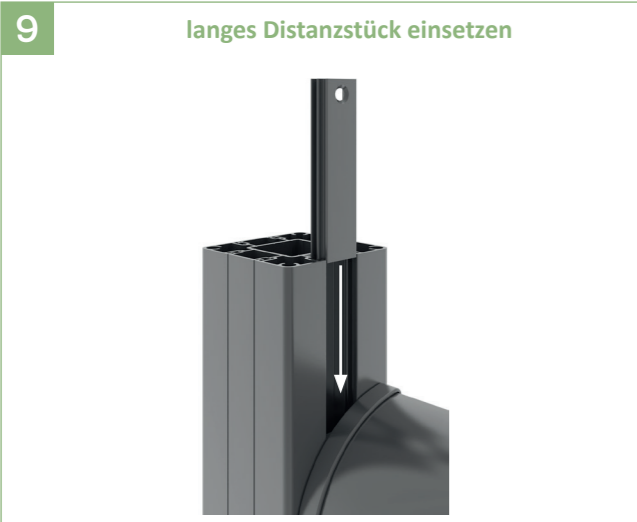
9 | Zum Schluss das lange Distanzstück nach Bedarf kürzen, vorbohren (d=4,5mm) und senken, dann von oben in den Pfosten einschieben.
