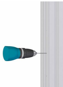
anzeichnen, ankönnen und vorbohren ...
