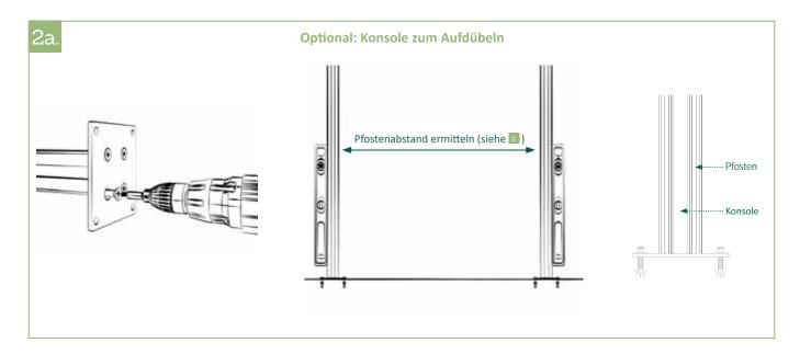
2a | Konsolen auf die Pfosten stecken und mit den mitgelieferten Schrauben von unten fest verschrauben. Ausrichtung der Konsolen bei aufgesteckten Pfosten, danach auf den Untergrund aufdübeln. Die Pfosten schließen nach dem Aufsetzen bündig mit den Konsolen ab.
