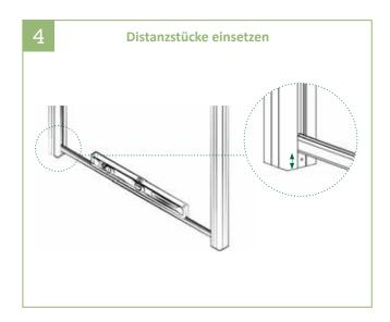
4 | Zuerst auf einer Seite das Distanzstück befestigen. Das Distanzstück der zweiten Seite mit Hilfe der U-Leiste und einer Wasserwaage ausrichten und befestigen.
