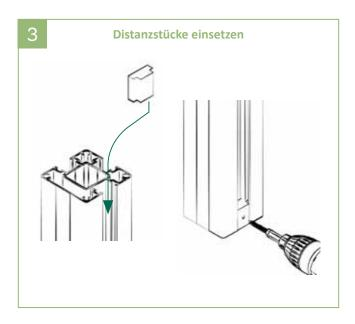
3 | Distanzstück hochkant in die Innenseite der Pfostennut einschieben, bündig mit der Unterkante des Pfostens abschließen, vorbohren und verschrauben.
